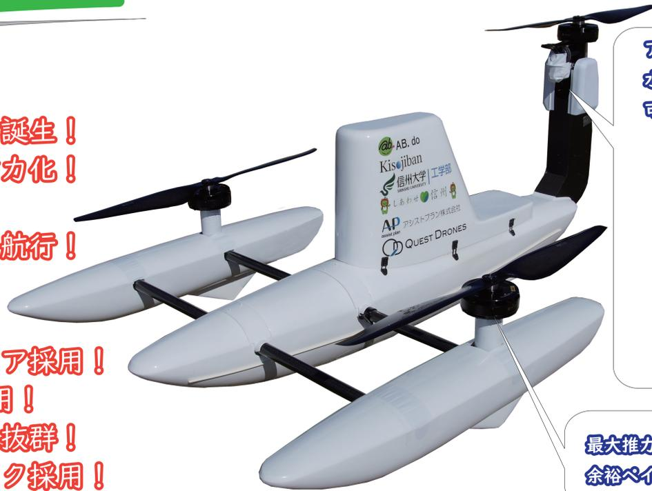
アクティブリトラクトシステム採用により、水上航行時の様々な状況に応じて角度可変機能により高速航行実現！
